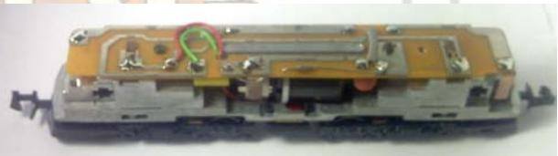
en digital, los eliminamos todos, prácticamente dejamos la placa limpia ya que no nos hace falta nada. Llama la atención los dos cables ( Rojo y verde) que se ven que “suben” de la zona del motor hacia arriba, atravesando la placa del circuito impreso. Estos dos cables son los que van a un commutador que se
